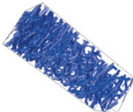
Oben: Im Rechner generierter Schichtaufbau, bestehend aus einem offenporigen Schaum, der von beiden Seiten mit einem Vlies abgedeckt ist.
