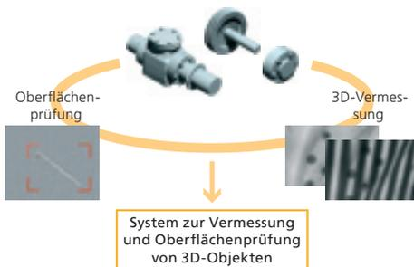
Kombinierte optische Vermessung und Oberflächenprüfung
