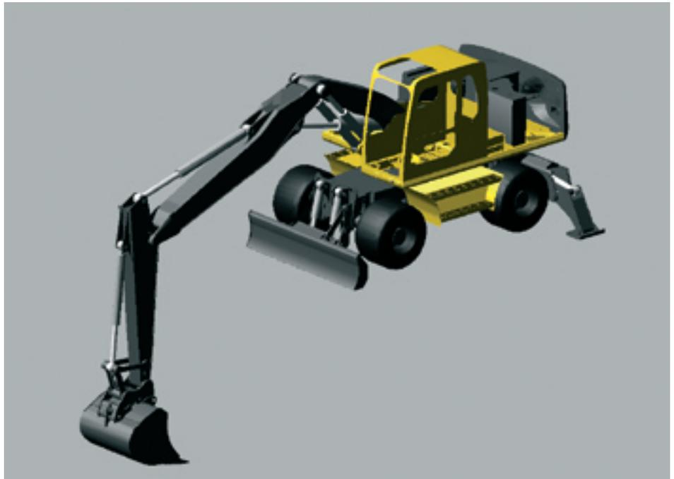
Mehrkörpersimulationsmodell eines Baggers
